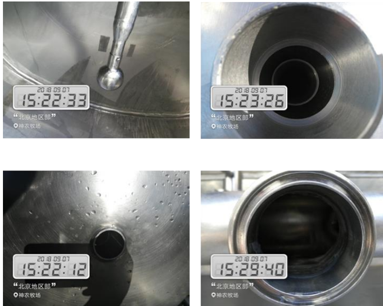
图 3 缸盖内侧、缸盖垫圈、缸盖透气阀、奶罐喷头、卸奶口管道接口检查
